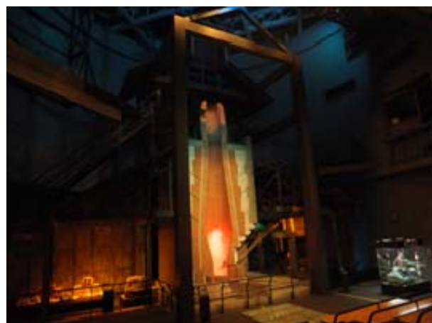
図3 橋野鉄銑山三番高炉原寸模型(手前が湯出口)(鉄の歴史館蔵)
