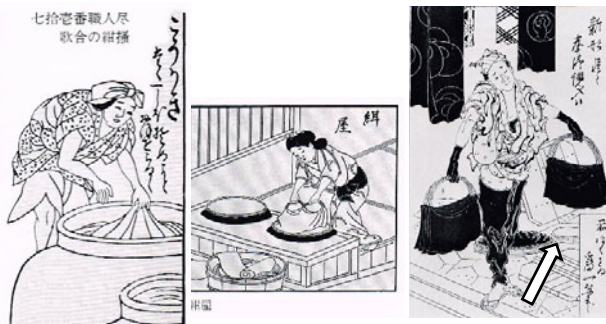
図 12 藍染めの温度管理の変遷. 左：（室町時代）甕は大気中に設置．中央：（元禄年間）土中に埋めて保温．右：（文政年間）火壺と呼ばれる加熱装置（矢印）が加えられている[10].
