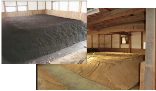
図 11 左上：藍葉の床（とこ）．内部温度が均一になるように中央部を低くしている．右下：“ふとん”をかけて保温した状態
