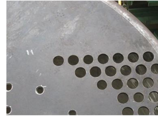
図 13 管穴の実例(㈱ヒラカワ製造部による)
