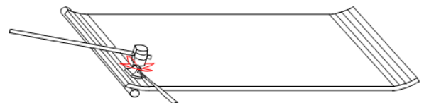
図9 ハンマーによる端曲げ加工
