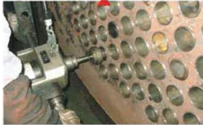
右回転で管を拡げながら前進, 左回転で抜ける
