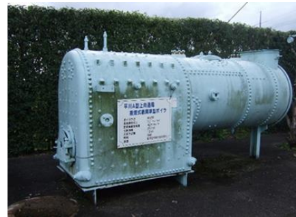
図 5 機関車型ボイラ(ケワニボイラ) (株ヒラカワボイラ歴史記念館)
