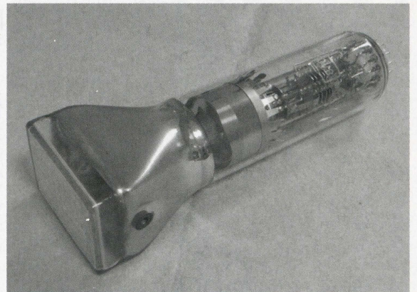
図2 CRT (カソード・レイ・チューブ)
