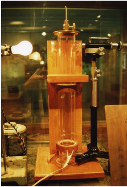
図2. 人工雪製作装置 (雪の科学館に展示されている)
