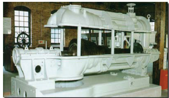
写真 7 わが国最初の国産陸用蒸気タービン
