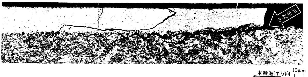
図 4 ダークスポットの縦断面（レール軸心より、ゲージコーナ側 12 mm、表層はホワイトフェーズ）
