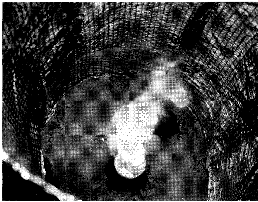
図1 円筒内の灯油燃焼炎（容器直径8cm）による 旋回炎
